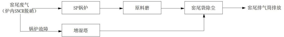
图 4.1-1 窑尾废气流程
